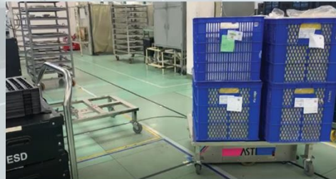
AGV trong nhà máy (AGV in factory)
